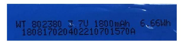
Inner Cell Model WT 802380, by Ningbo Huitong New Energy Technology Co., Ltd 内部电芯, 型号WT 802380, 电芯生产工厂宁波慧通新能源科技有限公司
